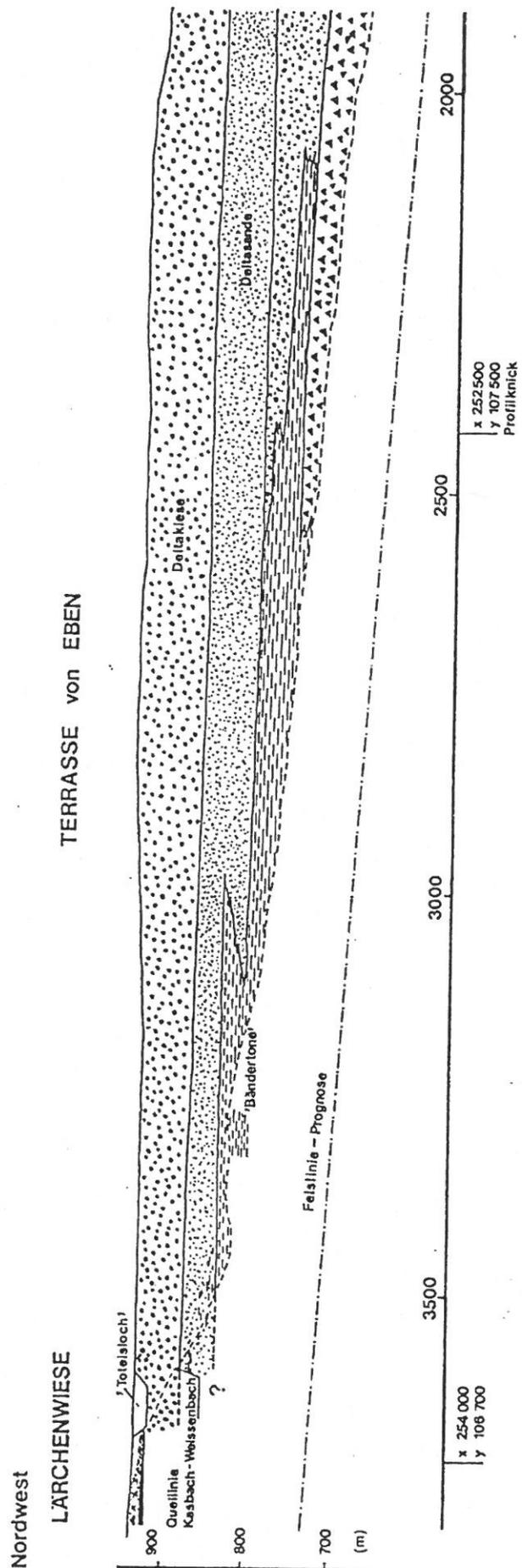
Abb. 4 Profil durch den Achenseedamm; Projektion in Schnittebene (Schnittverlauf lt. Abb. 3)
